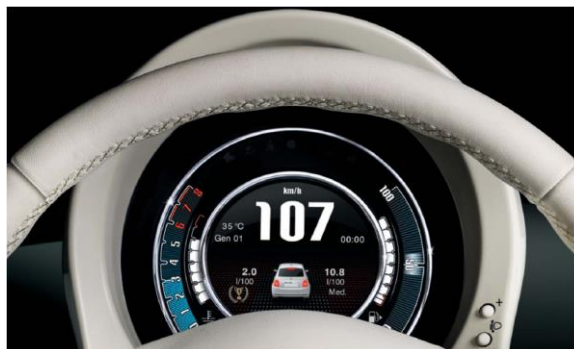
Цифрова РК-панель приладів TFT з кольоровим дисплеєм 7"
